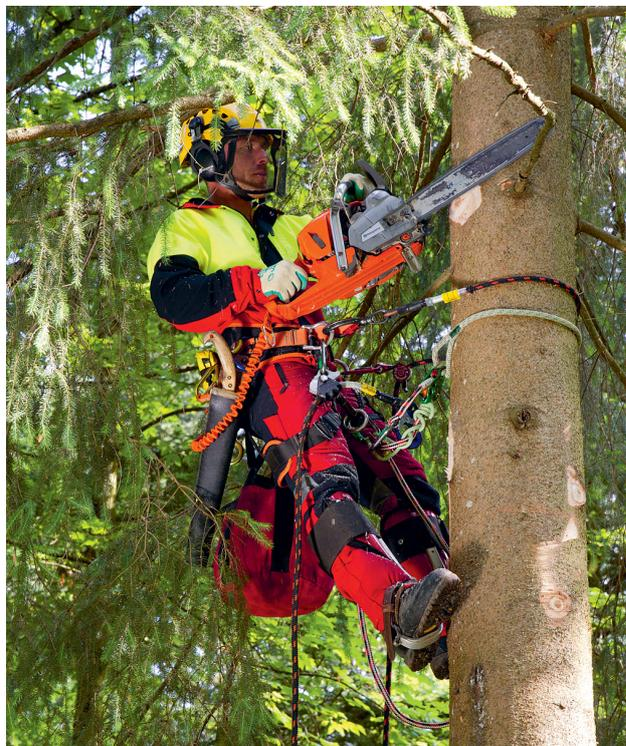
Arbeiten mit der Kettensäge: doppelte Sicherung mit Durchtrennschutz
